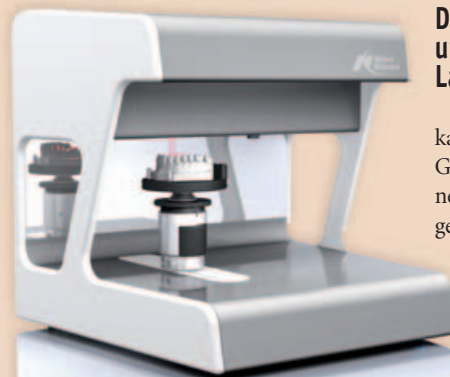
Abb. 1: Schematische Darstellung des neuen NobelProcera ™ System Scanners (Nobel Biocare ™ , Zürich), basierend auf einer lichteoptischen Objekterfassung mittels konoskopischer Holografie.
