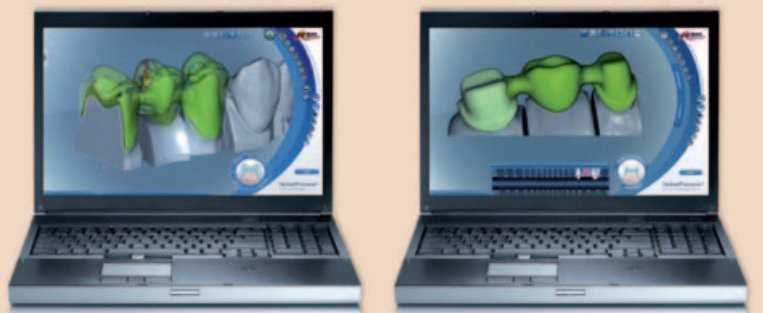
Abb. 2a und 2b: Eine deutliche Effizienzsteigerung im zahntechnischen Labor stellt die Gerüstgenerierung auf der Grundlage einer virtuellen Zahndatenbank dar. Nach einem automatischen „Vorschlag“ der Gerüststruktur durch die Software, kann diese virtuell an die Nachbarbeziehung angepasst werden. Ebenfalls voll automatisiert erfolgt im Anschluss die Erkennung der Präparationsgrenzen und die richtige Ausformung der Brückenstruktur, sowie ein „Cut-back“ für die Verblendkeramik (NobelProcera ™ Software).
