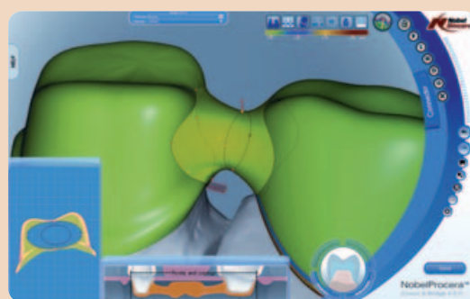
Abb. 3: Ein wesentlicher Aspekt für den langfristigen Erfolg von Brückenkonstruktionen aus Oxidkeramik ist das Design und die Stärke der Verbindungselemente zwischen Brückenglied und Brückenanker. Neben der Kontrolle der Gesamtquerschnittfläche können die vertikale Höhe und die verbleibende Höhe für die Verblendkeramik leicht kontrolliert werden (NobelProcera ™ Software).
